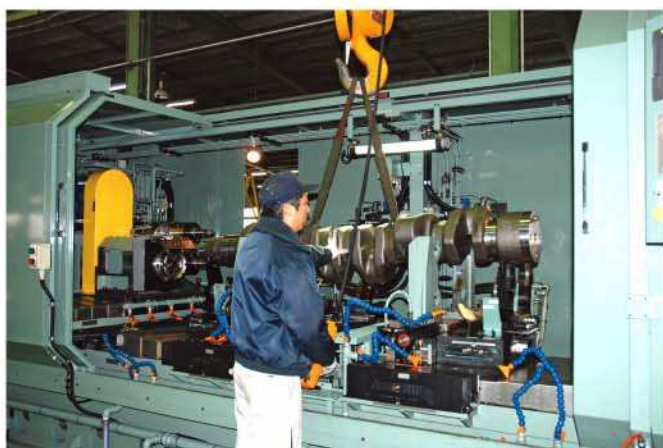
クレーンによる加工物の取り外し風景
