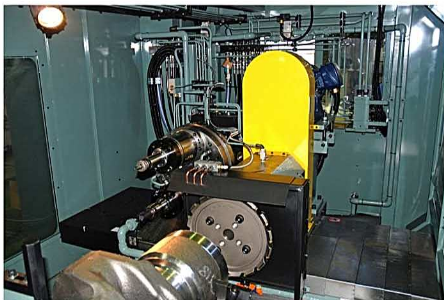
R側ミーリングユニット、 ドリルユニット
