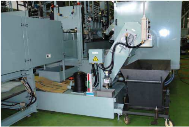
クーラント、チップコンベヤー
