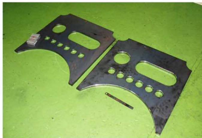
切断素材—左とR面取り加工済品—右
