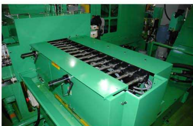
搬出コンベヤー
