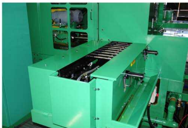
搬入コンベヤー
