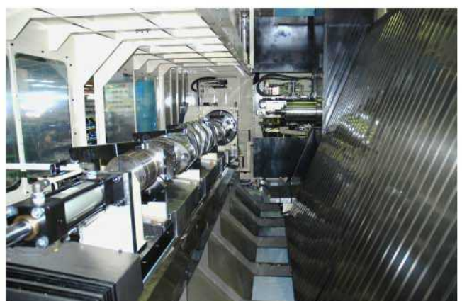
作業部—カバー内、下側はチップコンベヤー
