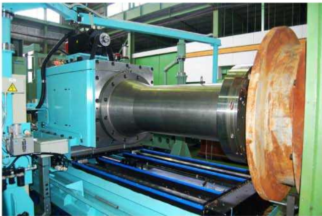
ボーリングユニット、テストピース
