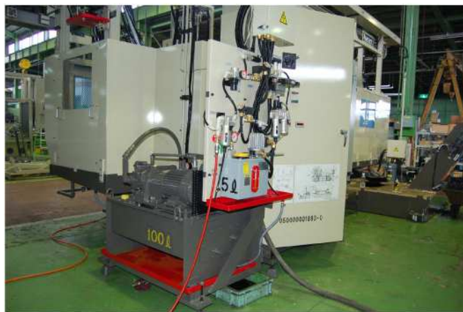
油圧、潤滑ユニット
