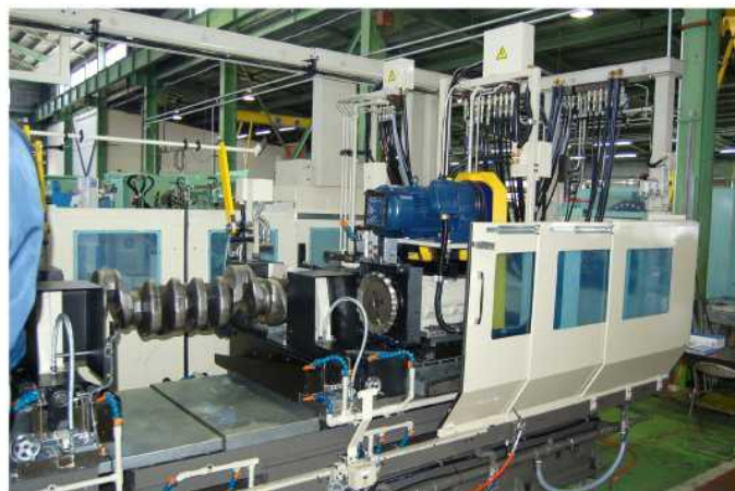
機械右側部 右側ヘッド部全体は加工物の長さに合わせて 全体の移動ができます
