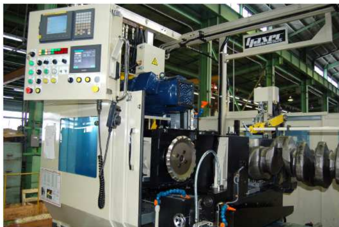
機械左側にペンダントタイプの操作盤を配置しています
