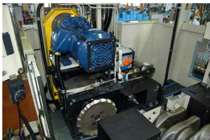
左加工ヘッド部 手前側 ミーリングヘッドユニット 11kw、150rpm 奥側 センタードリルユニット 2.2kw、310rpm
