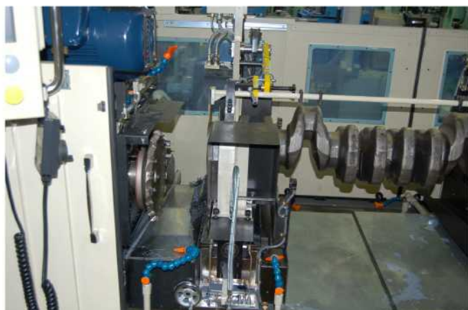
左クランプユニット部 カッター、ドリル下側は傾斜カバーにより 切粉は後部へ容易に排出されます
