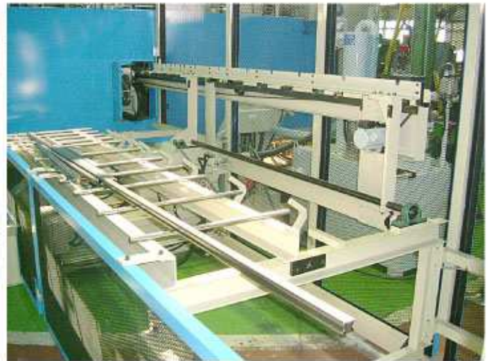
▲レール受けだし装置及び搬出ストッカー
