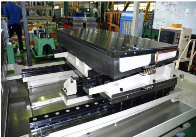
スピンドルヘッド送り用スライド構造 上側傾斜スライド—高さ調整用 下側スライド—スピンドルヘッド前後送り用
