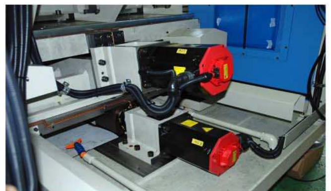
スライド後部—送り駆動装置 上側—ヘッド高さ調整用モーター 下側—ヘッド前後送り用モーター
