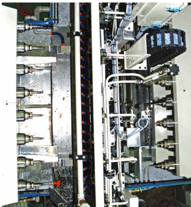
スピンドル配置—上側より見る 左側—座グリ加工スピンドル 右側—下穴加工スピンドル
