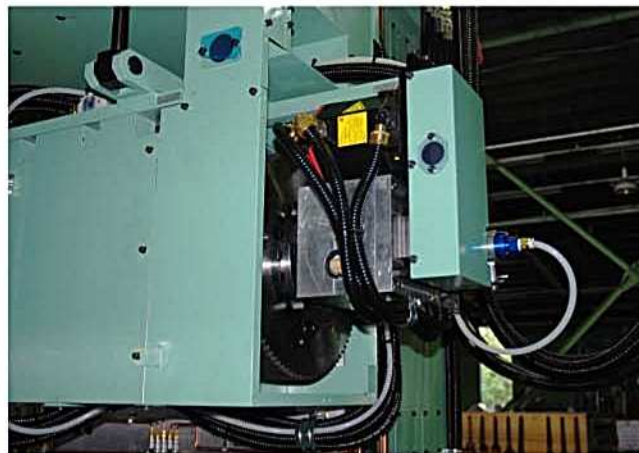
フェーシングストローク送り駆動部 (X軸)
