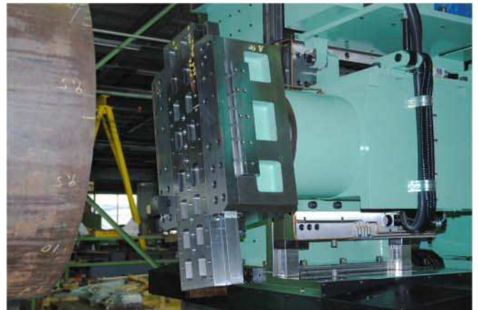
フェーシングプレート 寸法580×450mm フェーシングストローク280mm (X軸)
