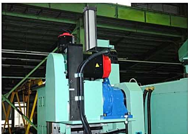
主軸駆動部 ACスピンドルモーター18.5/22kw 4/75減速機
