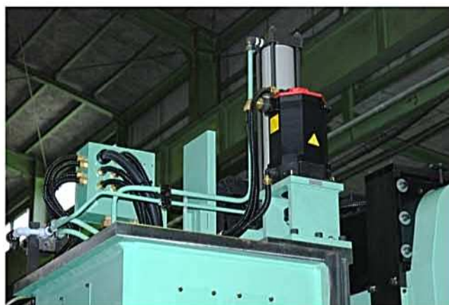
ヘッド上下送り駆動部 (Y軸) 及びカウンターウエイト用油圧シリンダー
