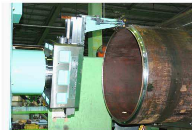
加工状況 パイプ径 \Phi 1100mm
