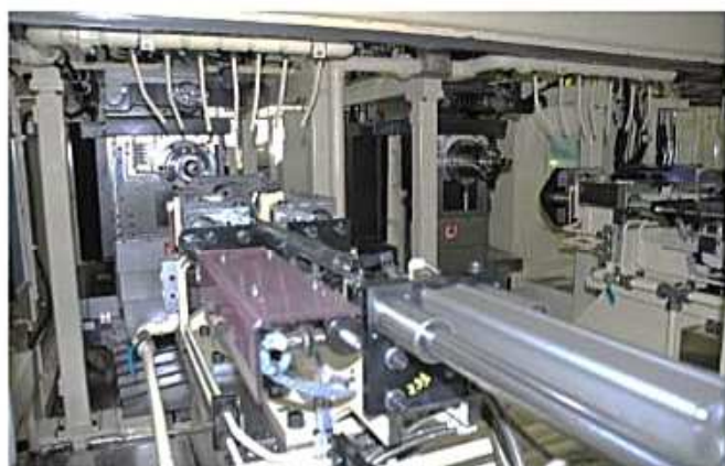
No1、No2 マシニングセルー穴明けST
