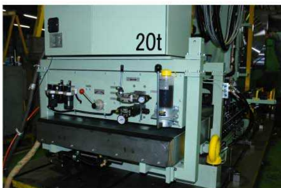
空圧、潤滑ユニット
