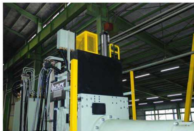
Y軸サーボモーター、カウンターバランスシリンダー
