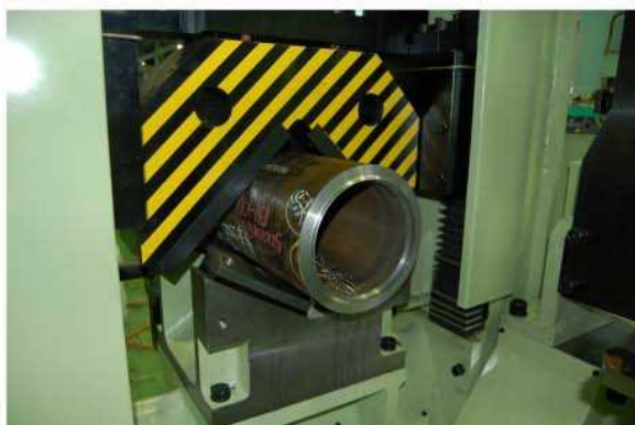
パイプ開先加工部
