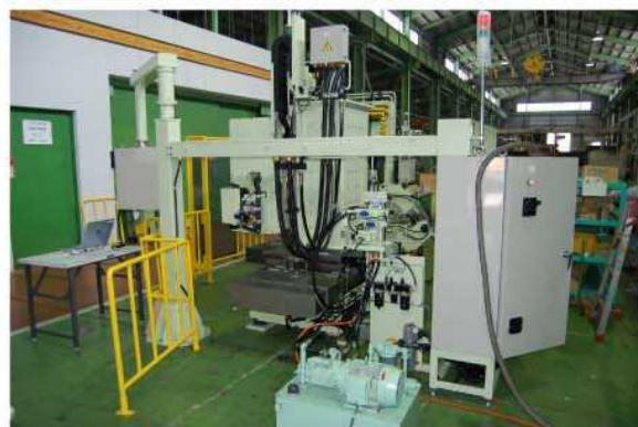
機械後面-電気、油圧ユニット
