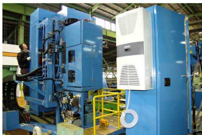
油圧、空圧、潤滑装置 電気制御装置はピット外側に配置されています
