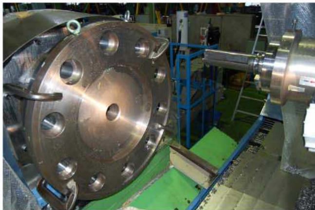
治具（前側）と共に取り付けられ加工される加工物
