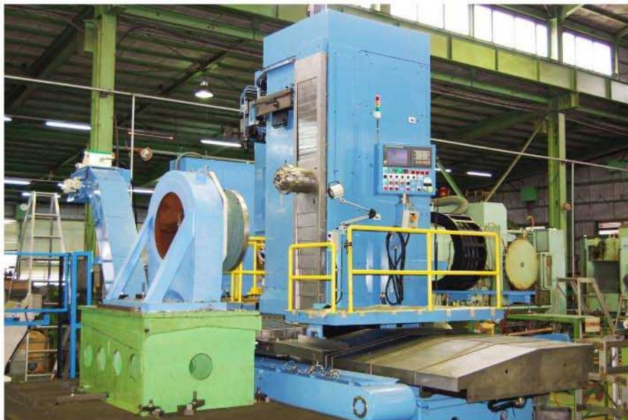
機械操作側 操作プラットフォーム及び 操作盤が前側に配置されています
