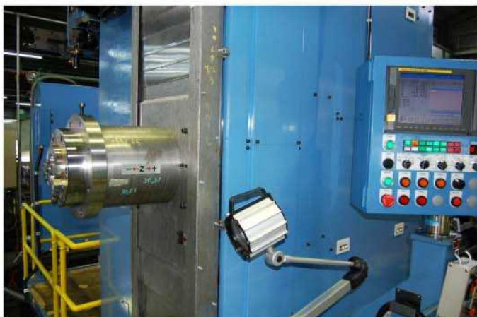
スピンドルヘッド BBT50、スピンドル径 \Phi 110mm
