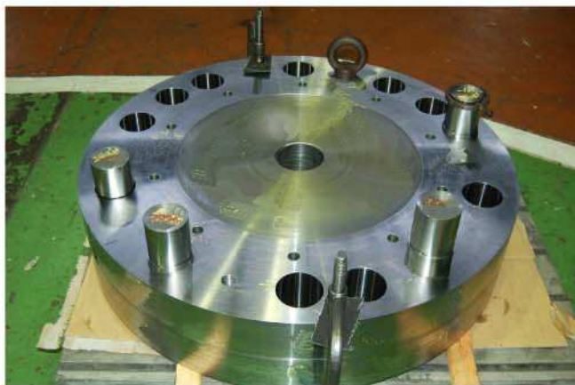
加工が完了した2枚を重ねゲージにてチェックされる加工物
