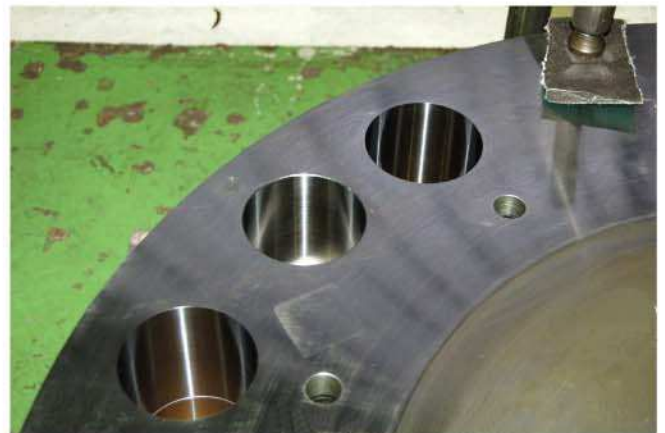
トレパニング工具にて穴明け後 ファインボーリングされた加工物
