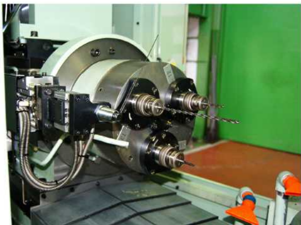
セットされた深穴加工用ドリルと 工具破損検知センサー
