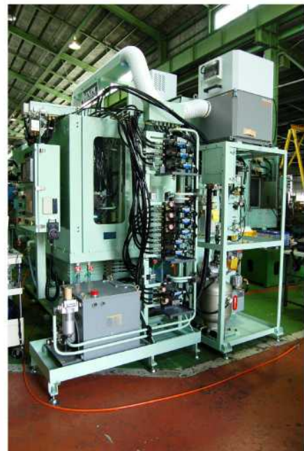
機械右側面—油圧、潤滑、MQL装置 ミストコレクター—上側
