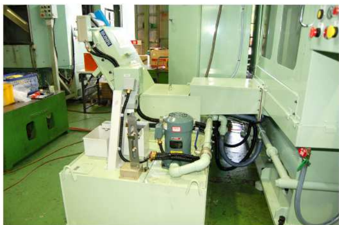
切粉押し流し液装置、チップコンベヤー
