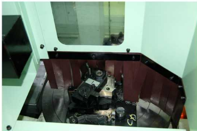
割出し式治具テーブルー加工物取り付け部
