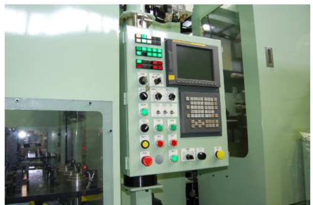
主操作盤 Fanuc 18i-MB CNC
