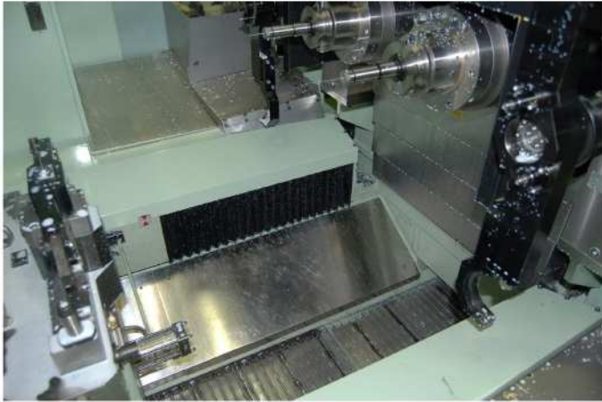
機械の中央に通したチップコンベヤー スピンドルの真下に配置されています
