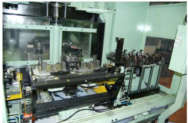
治具パレットと搬出加工物仮置台
