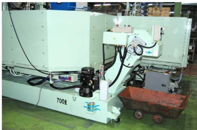
クーラントユニット、チップコンベヤー
