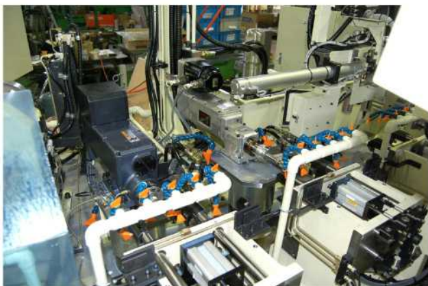
8ST1軸Dr—旋回機能付きヘッド 9ST1軸Tap—旋回機能付きヘッド
