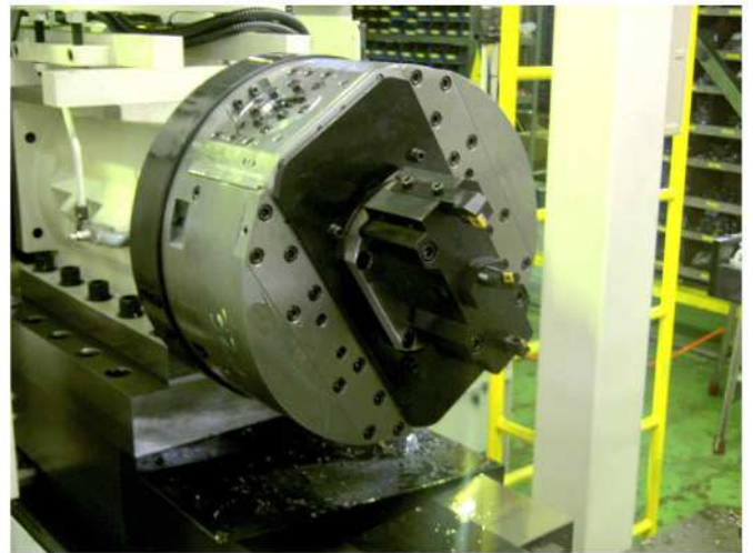
フェーシングヘッド 430外径 7.5kw
