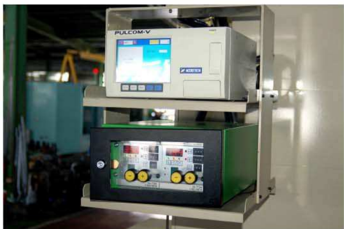
上側—計測制御部、下側—工具補正制御部
