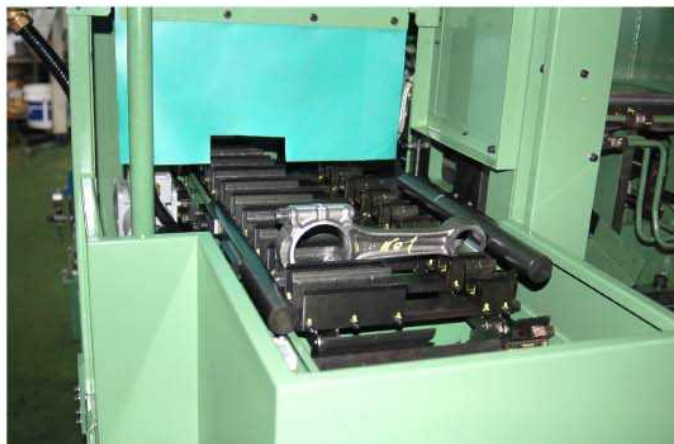
搬入コンベヤー
