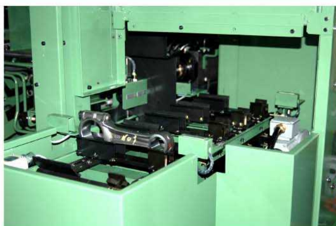
搬出コンベヤー
