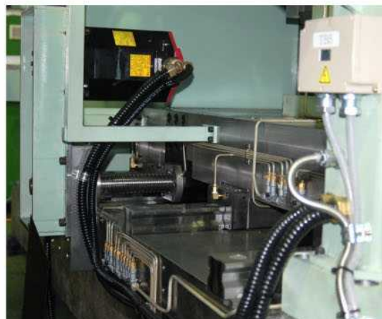
Z軸送り駆動装置 推力2800kgf
