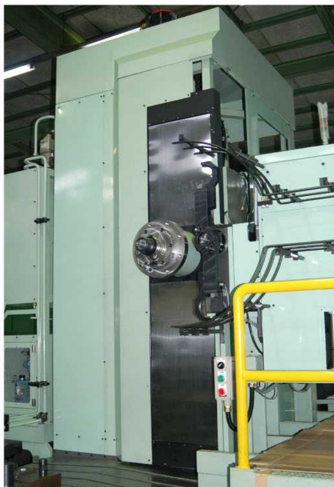
Y軸ストローク1300mm 工具交換はストロークの中間で行われる
