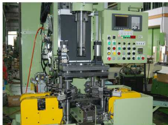
操作盤、治具、搬送装置部
