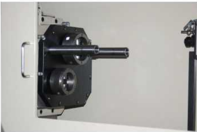
4ST、R 仕上げラインボーリングヘッド（後面）
