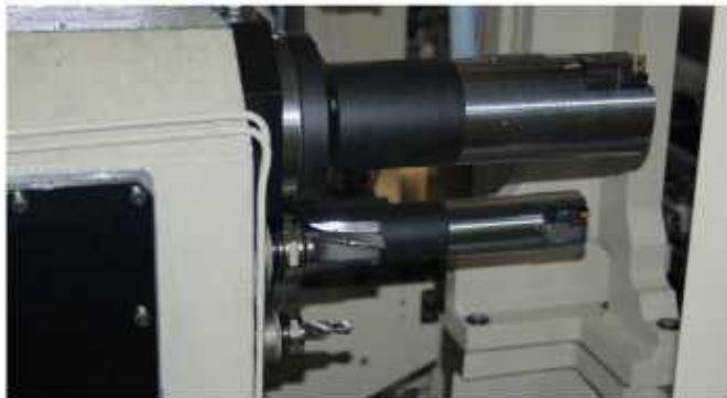
1ST、L ボーリングバー、ドリル
