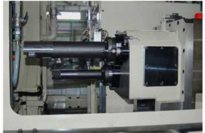
1ST、L 荒ボーリング、ドリル
