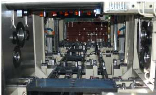
中央の搬送装置（搬出側より）
