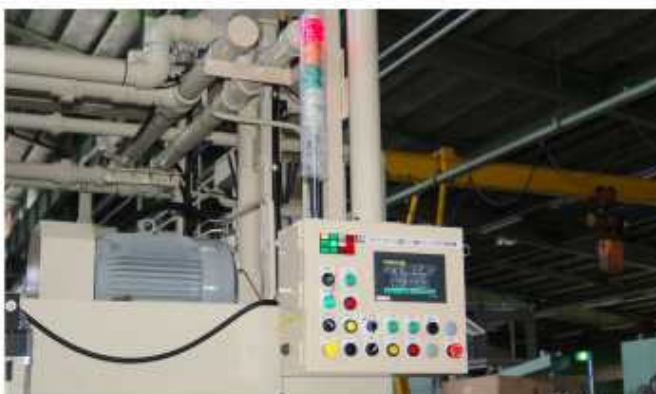
機械右側 操作盤及びクーラント配管
