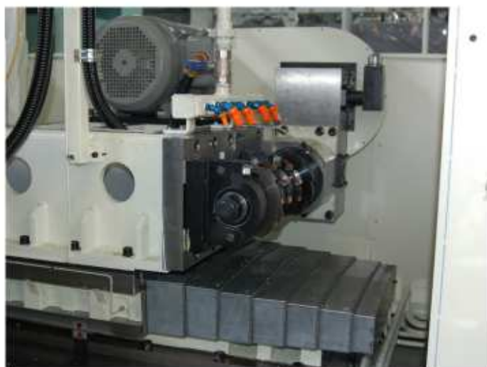
ミーリングヘッド組み合わせ式サイドカッター
