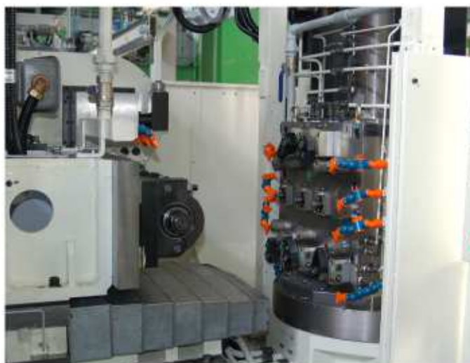
加工ヘッド、治具180度インデックスタイプ
