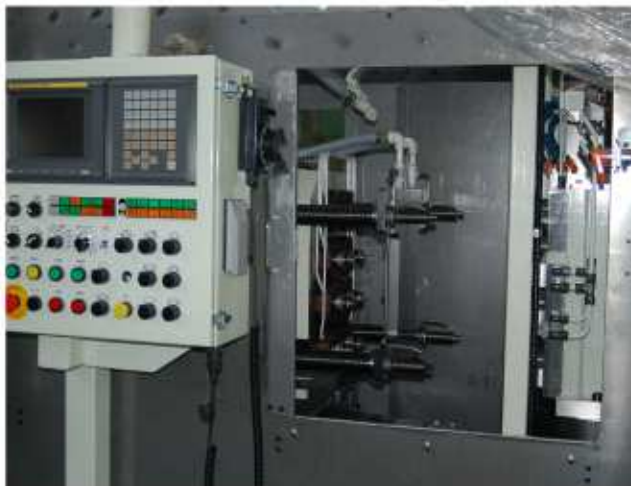
操作盤、多軸ドリルヘッド
