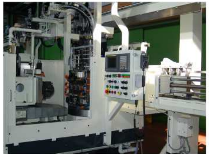
右側より加工物搬入部、操作盤、加工部分
