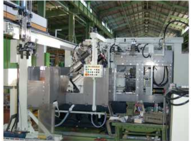
搬出側—前側にガントリーローダーが配置されている
