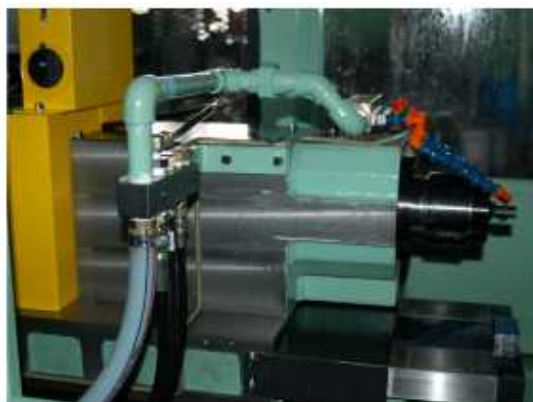
補正装置付きボーリングヘッド
