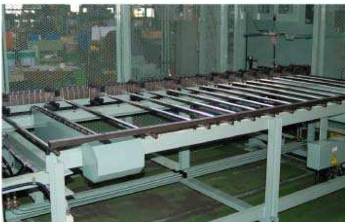
▲搬入ストッカー及びレール送り込み装置
