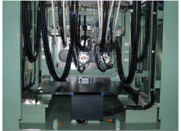
▲スピンドルヘッド後面 切粉流し用配管
