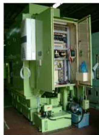
▲電気及びクーラント装置は後面に配置しています。
