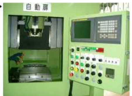
作業部と操作盤 ▶
