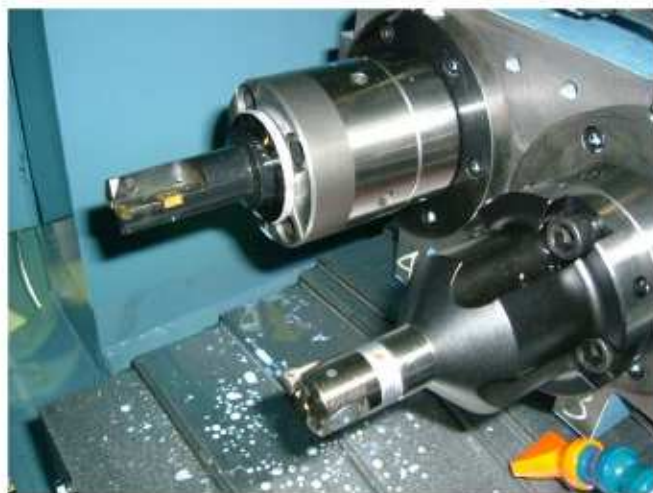
▲工具 奥側/ソリッドボーリング工具 手前側/ボーリング工具
