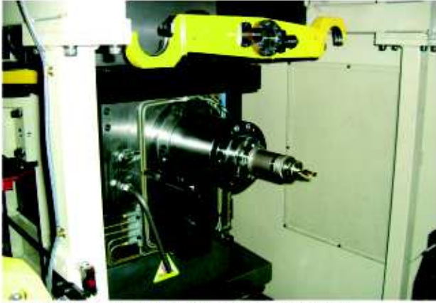
▲スピンドル、ATCユニット 下側はプッシャー
