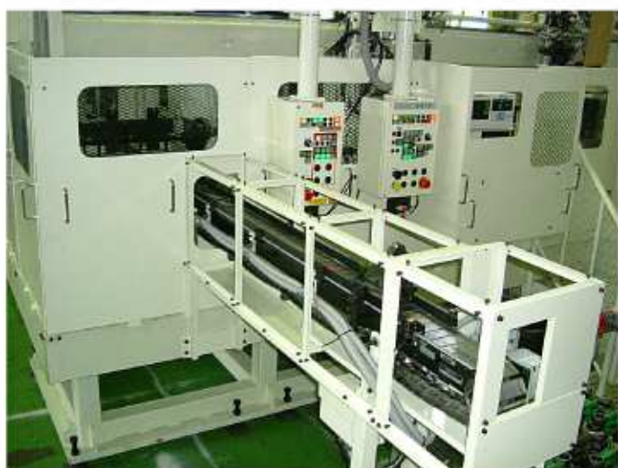
▲5ST/コンロッド搬出部及び操作盤
