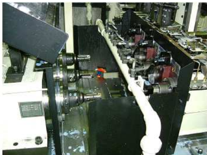
▲2ST/コアドリルによる高能率な穴明け、面取り
