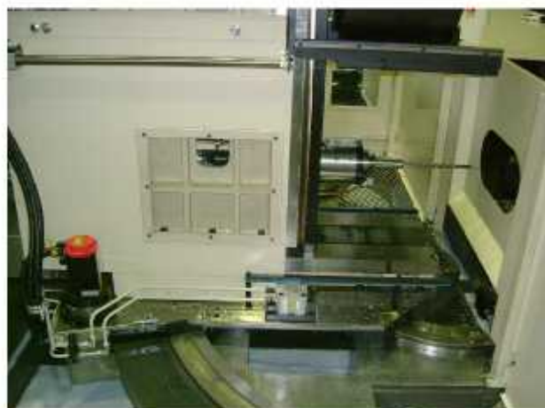
▲ スイベル駆動モーター、クランプ装置
