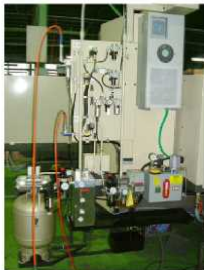
▲ スイベル駆動モーター、クランプ装置
