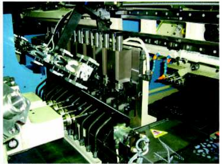
▲加工部分 治具及びスピンドル（搬出側より）
