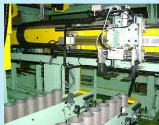
▲ 切断材取り出しローダー及び送り出しコンベヤー
