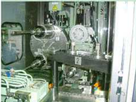
▲ボーリングヘッド(右)と2軸出シターレットヘッド
