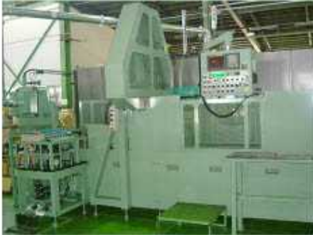
▲全体 アンローディングテーブル (左) パレット移載装置 (左上)
