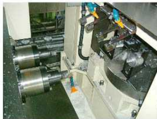
▲総型カッターによる加工作業部分
