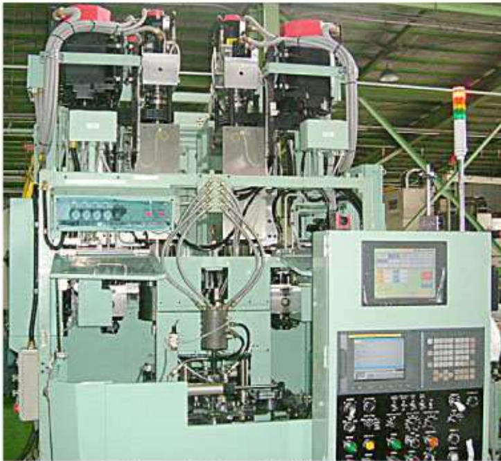
▲機械正面、スピンドルユニット2基、ローディング装置、操作盤
