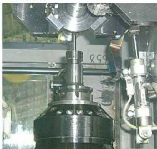
▲軸に直角な穴加工（下側より見る）
