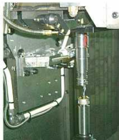
▲軸端面の穴加工
